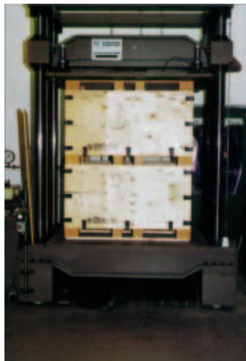
■ Caja de 12 mm sometida a una prueba de presión de 15 toneladas.
