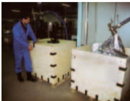
■ *Bombeo de aceite de pescado en bolsa desechable de 1.000 litros de capacidad. En el punto de entrega, se vacía rápidamente por una válvula en el inferior.*
